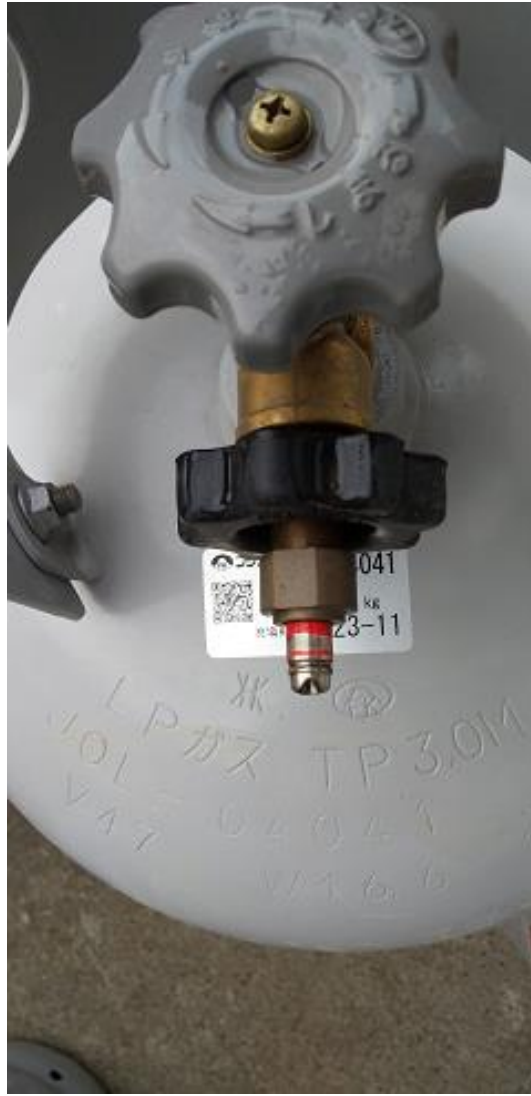
濁流により引きちぎられたガス放出防止型高圧ホース 防止機能が働いてガス漏れはなし
